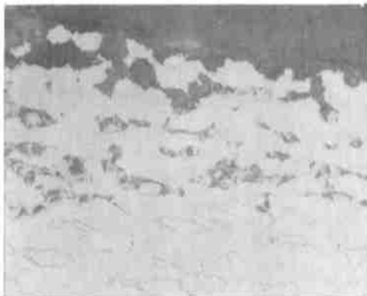
图 5 \alpha 连续的锡青铜(HSn62-1)榆林站实海暴露 4 年脱锌形貌(截面金相)× 300
